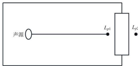
图4-2 室内声源等效为室外声源图例
